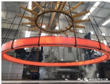
图1 大型整锻式不锈钢环形件
